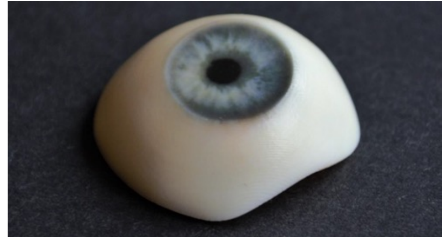
Vytisknuté jádro prototypu po odstranění podpor
