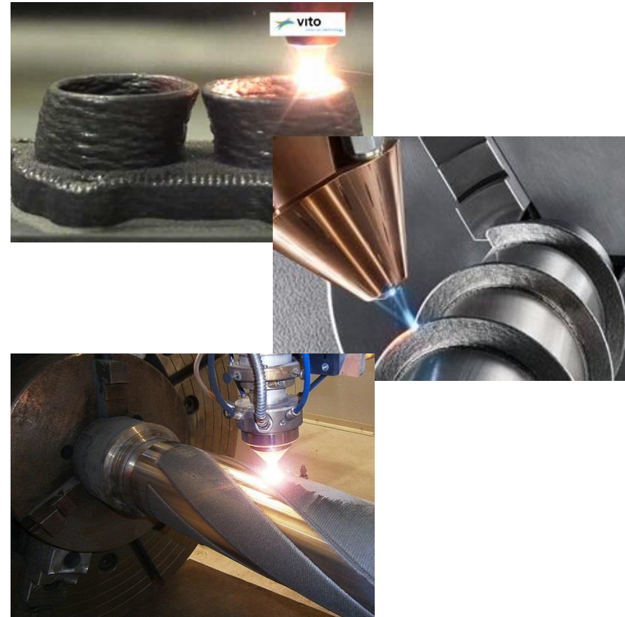
Navařování kovového prášku vháněného pod laser
